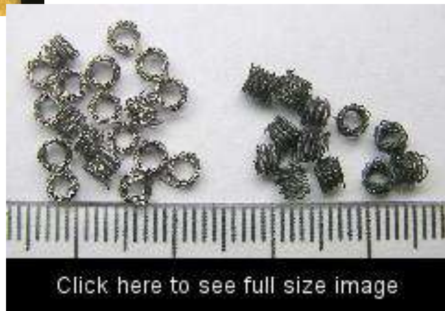
Вид насадки после матирующего травления «Царской водкой»
